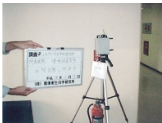
（室内空気中の石綿粉塵濃度測定状況）
