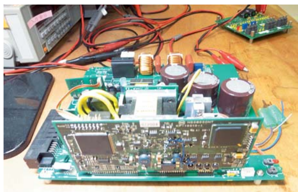
開発した新しいサーバ用電源の外観と内部回路
