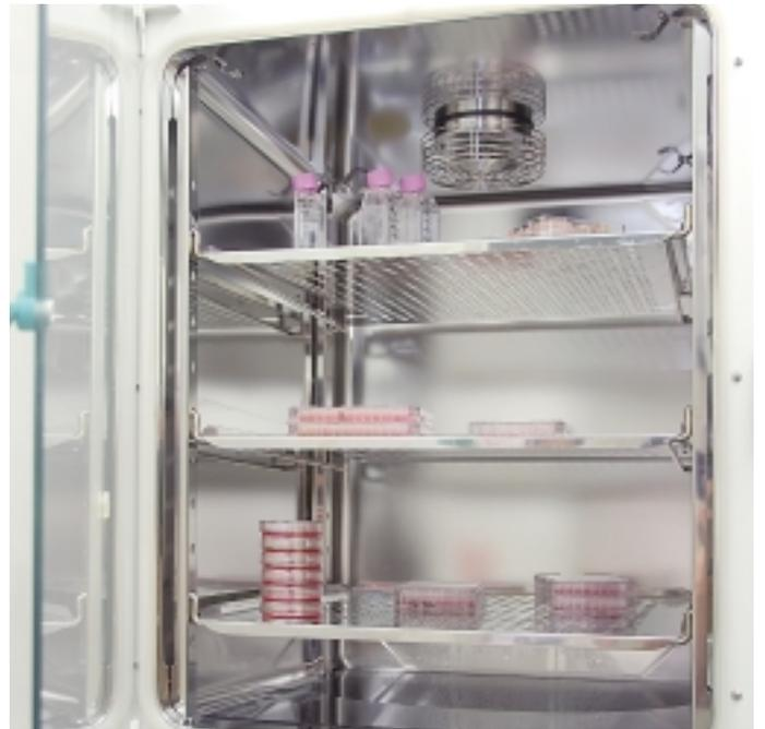
実験に使う細胞を人工的に飼育するCO<sub>2</sub>培養装置
