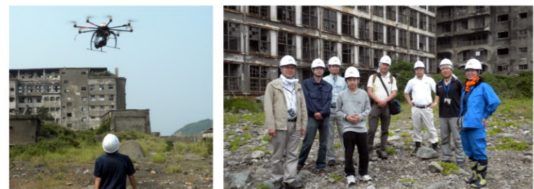
写真上／島の建物のなかでも30号棟は、大正時代に建てられた日本最古の鉄筋コンクリート造アパート。細かなひび割れまでわかる高精度の3Dモデルが完成しました。3Dデータから3Dプリンターを用いて30号棟の模型も製作。左下／デジタルカメラを載せた無人飛行機を飛ばすようす。右下／島に上陸して計測作業を行ったインフラ長寿命化センターのメンバー。夏は猛烈に暑く、冬は極寒というハードな作業だとか。3Dデータに関する問合せ・インフラ長寿命化センター ☎095-819-2880
