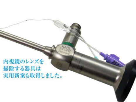
内視鏡のレンズを掃除する器具は実用新案も取得しました。
