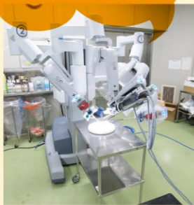
3D画像を見ながら多関節で360°動く鉗子で精密な手術を行います。
