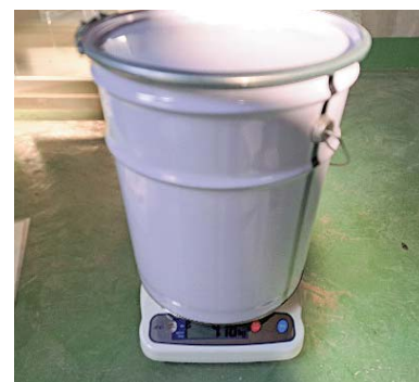
PCB 廃棄物の収納保管容器
