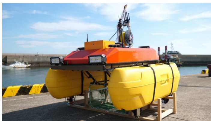
点検用無人艇：高解像度カメラや小型水中無人艇を搭載し、構造物の点検、採水を行う。
