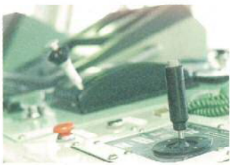
ジョイスティックコントロールシステム このシステムにより、旋回や横移動など複雑な操船をより精度よく行うことができます。
