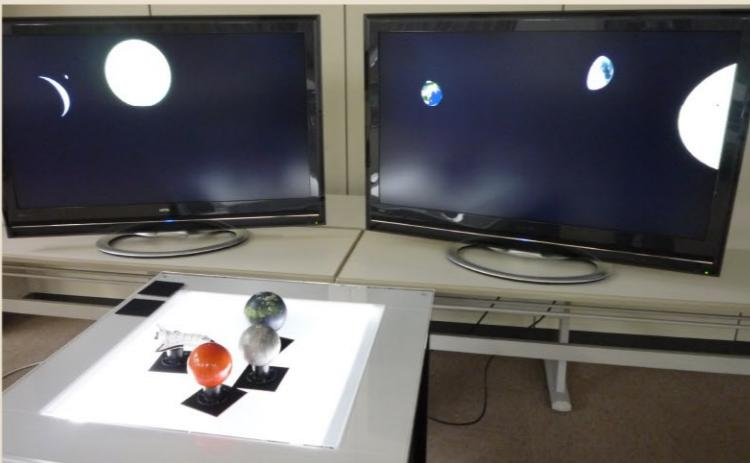
TUIとはTangible User Interfaceの略。タングブル=手で触れることが用いたインターフェースの一種。その一例がこれ。手前のスペースシャトルや地球などの模型を手で動かすと、モニターのなかの地球からの視点も動いて視点移動による空間の関係性がわかる機材です。模型の台の裏側に位置情報を読みとるしくみがあります。
