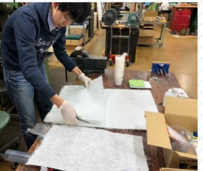
ロケットのボディを制作するための素材を加工中。
