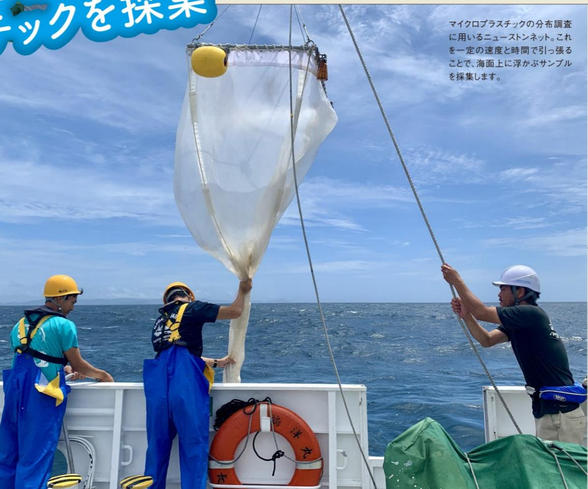
マイクロプラスチックの分布調査に用いるニューストーンネット。これを一定の速度と時間で引っ張ることで、海面上に浮かぶサンプルを採集します。
