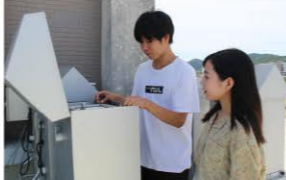
大学の屋上に設置している装置。PM2.5の表面に付着しているダイオキシンなどの物質を抽出。
