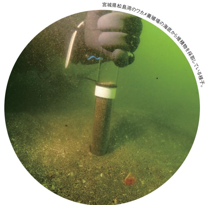
宮城県松島湾のワカメ養殖場の海底から堆積物を採取している様子。
