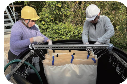
通常はロール状になった膜が多い中、汚れを除去しやすいよう封筒状に改良した膜を使用。フィルター、メッシュ、不織布などが層になっています。フィルターの孔のサイズは、1ナノメートル(1mmの100万分の1)未満。肉眼では見えません。
