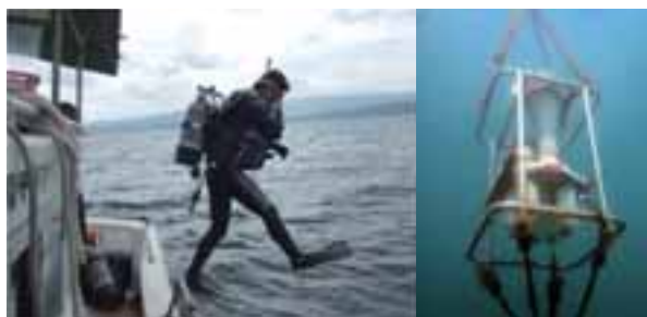
潜水による試料採取（左）とセジメントトラップ（右）
