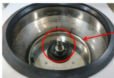
駆動ピンの変形を目視にて確認する。
