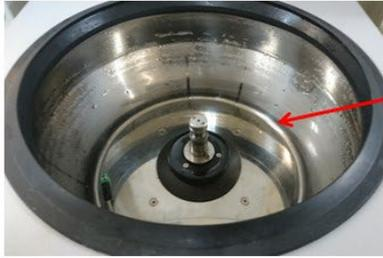
冷却遠心機など低温で遠心した場合、水滴が内部に付着する。放置するとパッキンなどの腐食が進むため、キムタオルなどで拭き取り、蓋を開けたまま電源を切っておく。
