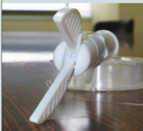
しなやかな動きと強く掴む力が特長的な外科手術用の「把持圧均一口ポット鉗子」。大学院山本都夫教授が院生と共同開発したものです。
