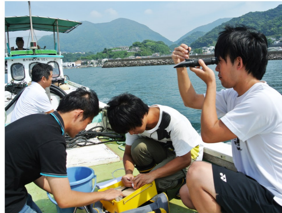
右の神近さんが持つ望遠鏡のようなものは、海水の塩分濃度を測る機器。海水はプランクトンネットを使って数カ所です取するため、手分けして場所名をラベリングしていきます(右から2人目が池北さん)。操業を阻害しないよう、手際よく行います。
