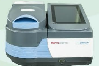
DNAやRNAのタンパク質濃度を測定する機器。そのそばには、さまざまなスピードの遠心分離機が並びます。
