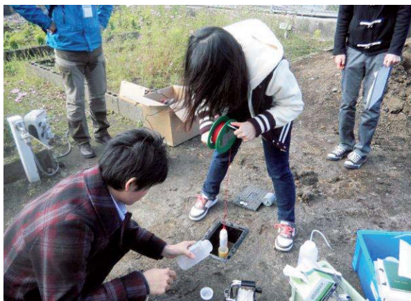
地下水サンプリング状況
