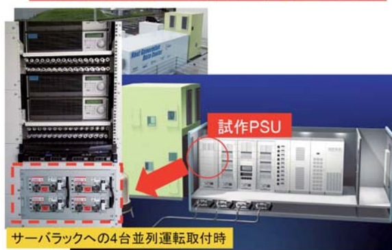
モジュール内のサーバ用に新しく開発した電源ユニットの外観
