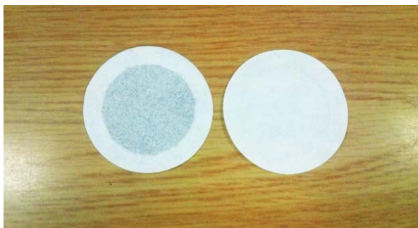
図2 すず捕集状況（左：軽油 右：ブタノール混合軽油）
