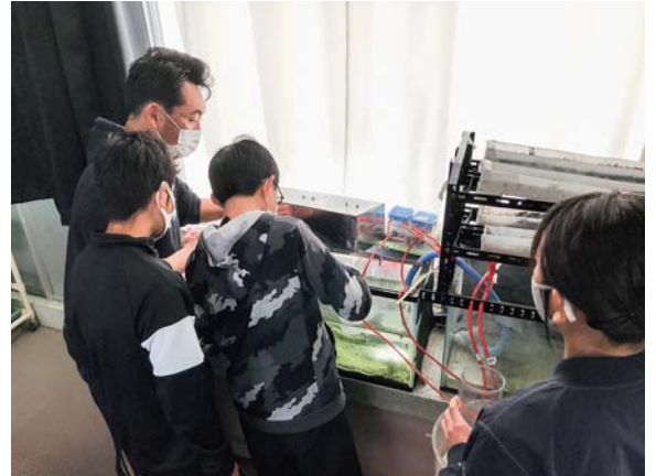
トウモロコシ炭と牡蠣殻による水槽で発生した藻類の浄化実験
