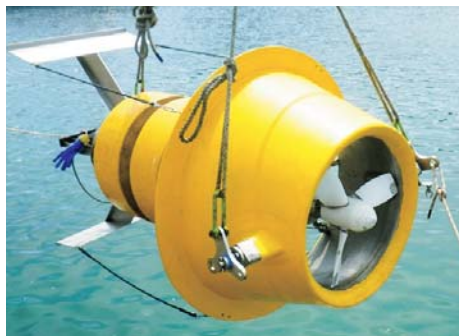
浮沈式潮流発電装置 (L×B×D= 2 m x1.1m x1.1m)
