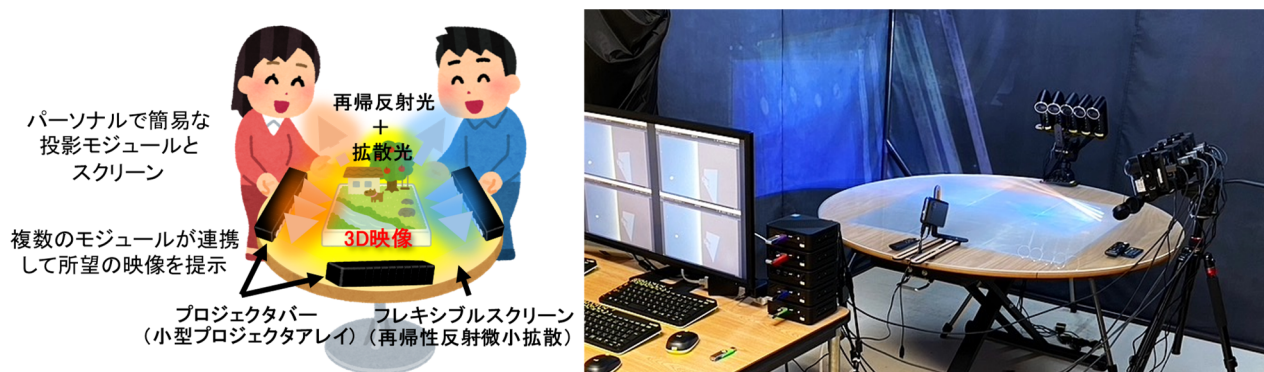
図2 現在進行中のパーソナル裸眼3D表示システムのコンセプトと実験風景
