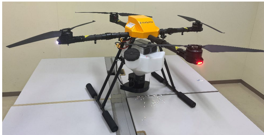
図 2. 給餌量をコントロール可能な検証用ドローン
