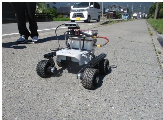
写真 1 歩行空間自律検査車両ロボット
