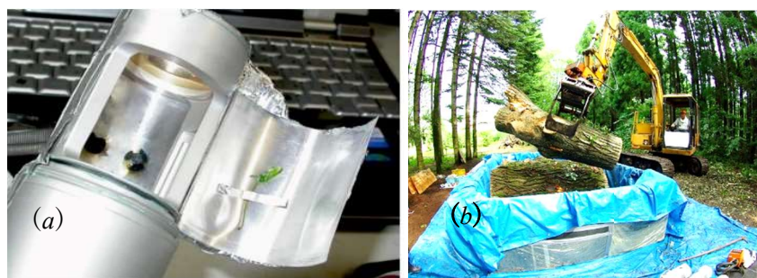
図 1. (a)木本植物の芽生えの呼吸測定の様子、(b)大木（樹高 34m）の幹を呼吸測定装置に入れる様子 大木は 8m 3 の装置で数回に分けて測定し、測定値を足し合わせて個体呼吸としました。植物のサイズに合わせて様々な大きさの装置で測定しますが、測定原理と CO 2 センサーは統一しました。
