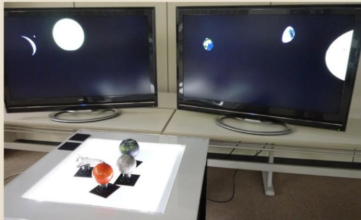
TUIとはTangible User Interfaceの略。タンジブル=手で触れることを用いたインターフェースの一種。その一例がこれ。手前のスペースシャトルや地球などの模型を手で動かすと、モニターのなかの地球からの視点も動いて視点移動による空間の関係性がわかる機材です。模型の台の裏側に位置情報を読みとるしくみがあります。
