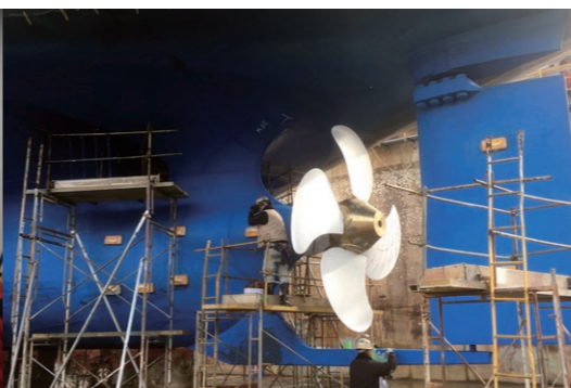
これがCFRPのプロペラ。弾力性に優れ、荒天時のエンジン負荷を抑えます。1,000トンクラスの調査・練習船への導入は世界初です。
