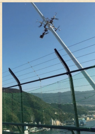
斜張橋のケーブルの傷を検査するメンテナンス機器。女神大橋などでの実証実験を経て、商品化されています。現在は全国各地の検査に使われています。
