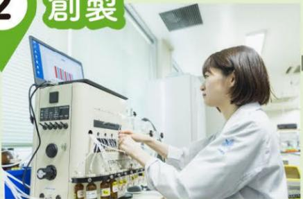
合成したものをDNAに組み込む際に使うDNA合成機。これでDNAを化学合成することで新しい素材(人工核酸)を開発します。
