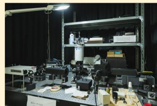
発光性金属錯体の励起状態の寿命を測定するための装置。こうした実験装置は総合教育研究棟の分析室に集められ、温度や湿度が一定に保たれた空間で管理されています。レーザーを使うので実験中は保護メガネが必須。
