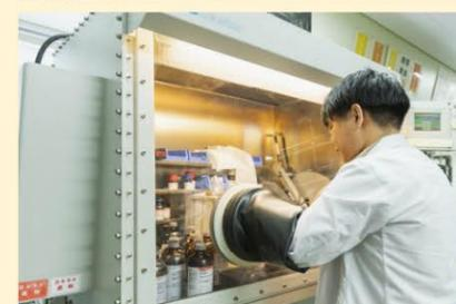
グローブボックスに窒素を充填することで空気中の酸素や水が入らない密閉空間を作り出し、空気不安定な化合物を扱うことができます。
