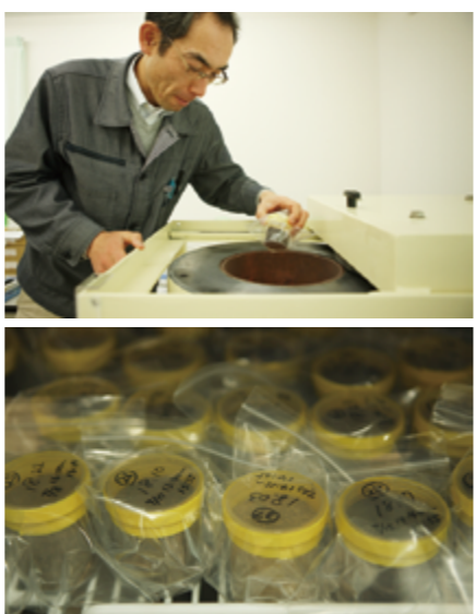
住民が検査を依頼したキノコなどは（下）、原子力安全研究協会が導入したゲルマニウム半導体検出器で迅速に検査できるようになりました。
