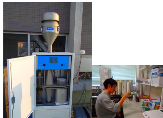
図4 長崎大学屋上でのPM2.5のフィルター捕集と抽出作業
