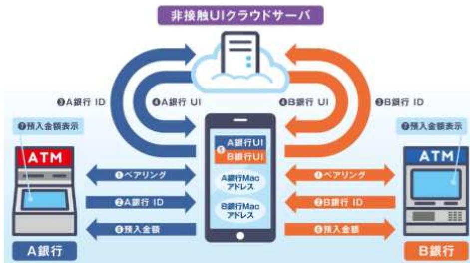
図1 スマホによる公衆機器向け非接触操作方式
