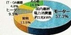
財団法人新機軸工業開発協会の2009年度調査データより筆者がグラフ化。2005年の日本国内最終電力消費量の57.3%をモーターが消費。
