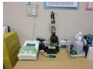
室内環境測定装置
