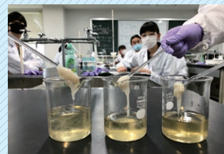
海藻からアルギン酸を抽出・分離する 学生実験の様子
