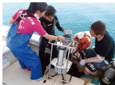
漁船上で、大村湾の海底近くに設置するセジメントラップの準備中(沈降粒子を捕捉する係留装置)
